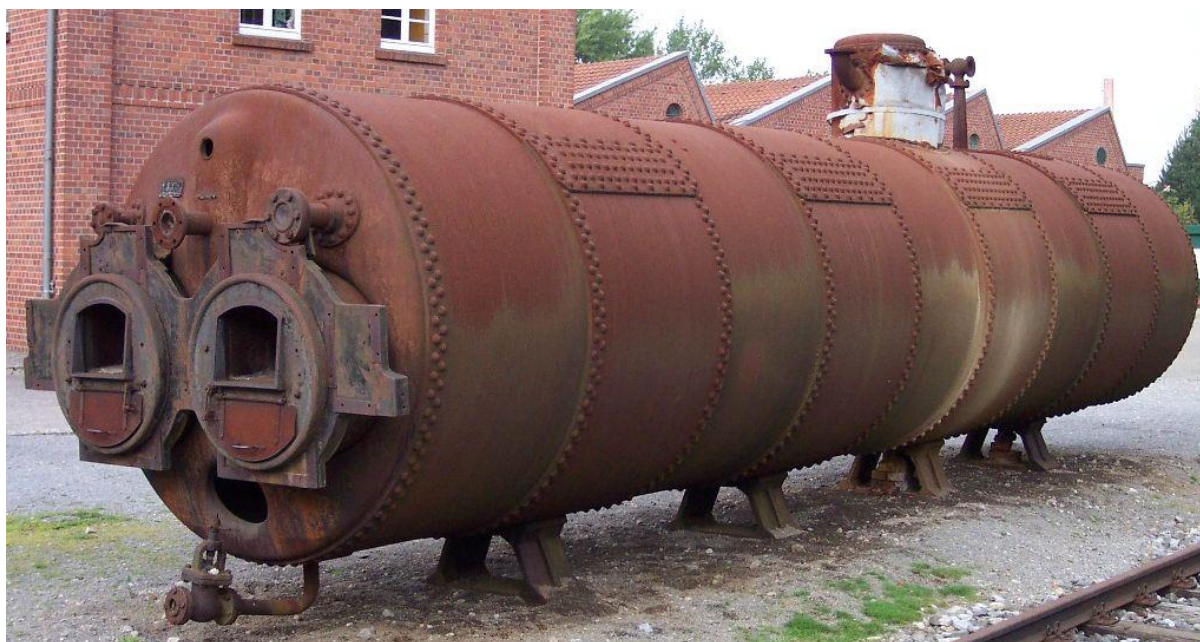
دیگ بخار صنعتی قدیمی که بخار مورد نیاز یک موتور بخار ثابت را تامین میکرده
