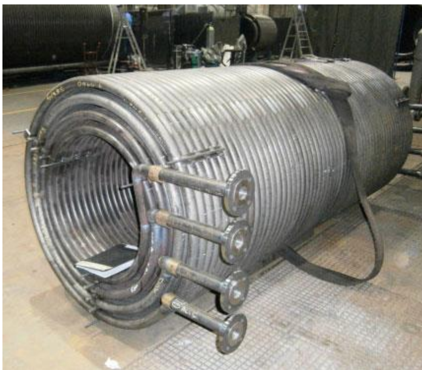
شکل بالا چهار کویل مارپیچ تو در توی تک نخ را نشان می دهد.
